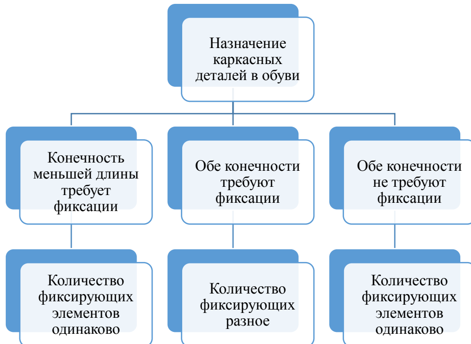
Рисунок 4.9 Рекомендации по распределению фиксирующих элементов в обуви с разной длиной следа
