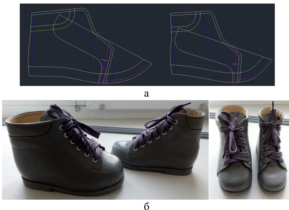
Рисунок 4.4 - Примеры чертежа (а) и готовой модели обуви (б) ультра-кастомизированной обуви с разными обхватными параметрами
