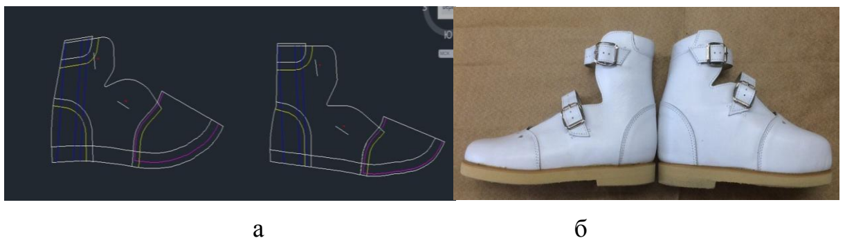
Рисунок 4.11 – Чертеж (а) и фотография (б) готовой обуви при укорочении конечности
